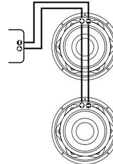
Восемь динамиков 8 Ом @ 8 Ом при последовательно-параллельном подключении
