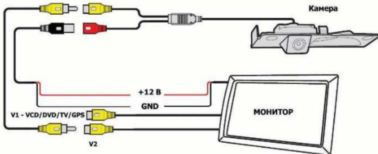
Дисплей включается автоматически при поступлении сигнала на видеовход.
